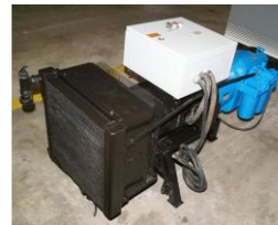
Referencia: TIG-022 COMPRESOR DE PISTON 11kw Año: . Marca: HYDROVANE
