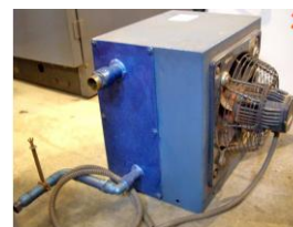
Referencia: BUS-006 REFRIGERADOR AIRE-AGUA Año: . Marca: AIRSEC
