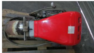
Referencia: DIV-003 QUEMADOR GASOIL Año: 1996 Marca: ROCA
