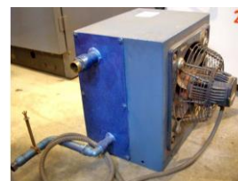
Referencia: BUS-006 REFRIGERADOR AIRE-AGUA Año: . Marca: AIRSEC
