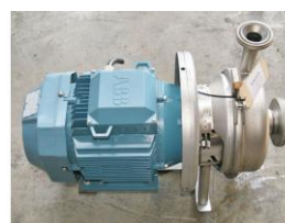
Referencia: SUN-051 BOMBA CENTRÍFUGA Año: 2005 Marca: APV
