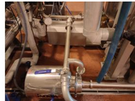
Referencia: DUL-002G BOMBA CENTRIFUGA Año: 2009 Marca: INOXPA
