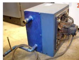
Referencia: BUS-006 REFRIGERADOR AIRE-AGUA Año: . Marca: AIRSEC
