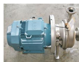
Referencia: SUN-051 BOMBA CENTRÍFUGA Año: 2005 Marca: APV
