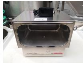
Referencia: LFR-041 DESINFECTADOR PARA PEQUEÑOS UTILES Año: . Marca: NICOMAC
